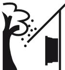
Proteger el inversor frente a piezas que caen que pueden penetrar en las aberturas de ventilación del inversor.
