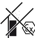
Ne pas installer l'onduleur dans des zones à risque d'explosion.
