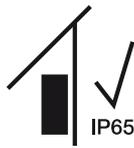
Wechselrichter im geschützten Außenbereich montieren.
