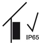
Wechselrichter im Innenbereich montieren.
