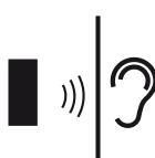
Střídač v provozu vydává hluk. Instalujte střídač tak, aby nikdo nebyl provozním hlukem rušen.
