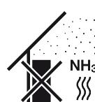
Chraňte střídač před prachem, nečistotami a čpavkovými plyny. Prostory a části s chovem zvířat jsou jako místo montáže nepřípustné.
