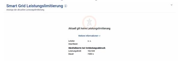
Unter *Smart Grid Leistungslimitierung* wird die aktuelle Leistungslimitierung (falls aktiv) angezeigt, welche vom Netzbetreiber zuletzt gesetzt wurde. Neben dem Leistungslimit wird auch dessen Gültigkeitsdauer dargestellt.
