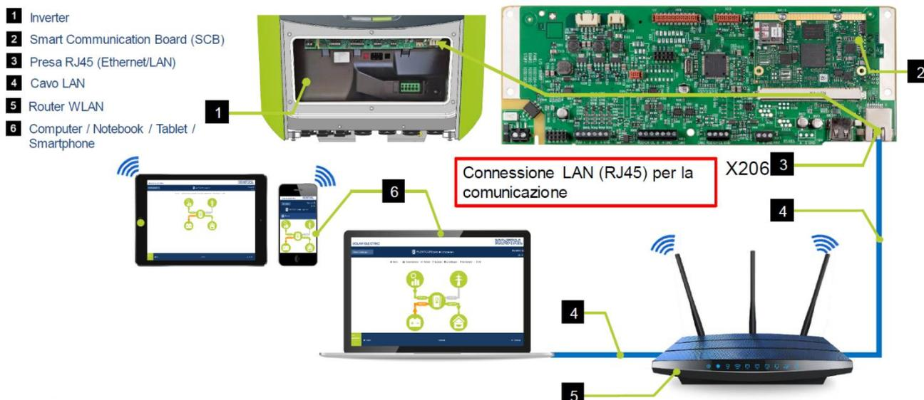
Se il cavo ethernet viene collegato a un router, l'inverter viene integrato nella propria rete e può essere interrogato da tutti i computer o inverter KOSTAL collegati alla stessa rete.
