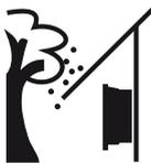
Proteger el inversor frente a piezas que caen que pueden penetrar en las aberturas de ventilación del inversor.
