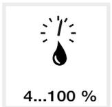
A humidade do ar tem de estar entre 4 % e 100 % (com condensação).
