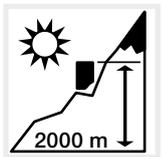
O inversor só pode ser montado até uma altura de 2000 m.
