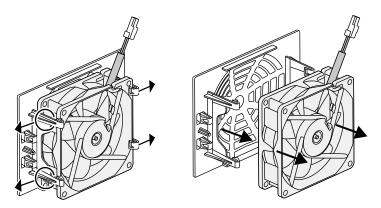
Fig. 76: Disassembly of the fan grill
