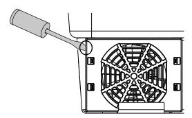
Fig. 73: Loosen fan grill
