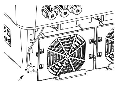
Fig. 75: Pull out fan cable
