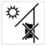
Ne pas installer l'onduleur chargeur à l'extérieur.
