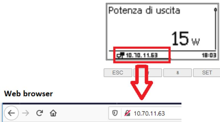
Nel caso in cui sia necessario aggiornare l'inverter e non si disponga di una connessione Internet nell'inverter, è necessario collegare un PC alla porta LAN dell'inverter e configurare un IP manuale nel range, come descritto di seguito.
