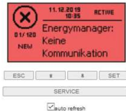
Dopo la configurazione, il display dell'inverter si illumina di rosso e mostra il seguente errore.
