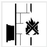
Monter l'onduleur sur une surface de montage ininflammable.
