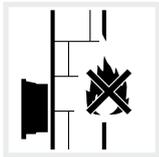
Montar el inversor en una superficie de montaje no inflamable.
