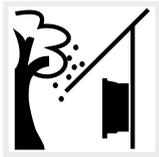
Proteger el inversor frente a piezas que caen que pueden penetrar en las aberturas de ventilación del inversor.
