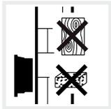
Montar el inversor en una superficie de montaje estable, que pueda soportar de forma segura el peso. Se prohíben los tabiques de yeso encartonado y los revestimientos de madera.
