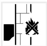
Montar el inversor en una superficie de montaje no inflamable.
