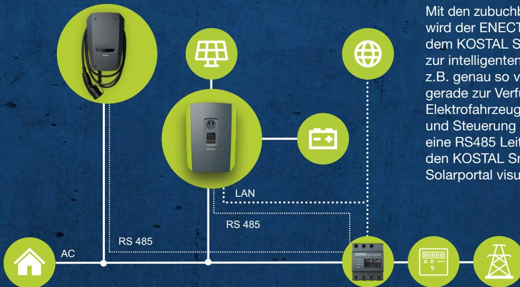
Mit den zubuchbaren Komfortfunktionen wird der ENECTOR in Verbindung mit dem KOSTAL Smart Energy Meter zur intelligenten Wallbox und lädt z.B. genau so viel Solarenergie wie gerade zur Verfügung steht in das Elektrofahrzeug. Die Kommunikation und Steuerung erfolgt sicher über eine RS485 Leitung und wird über den KOSTAL Smart Energy Meter im Solarportal visualisiert.
