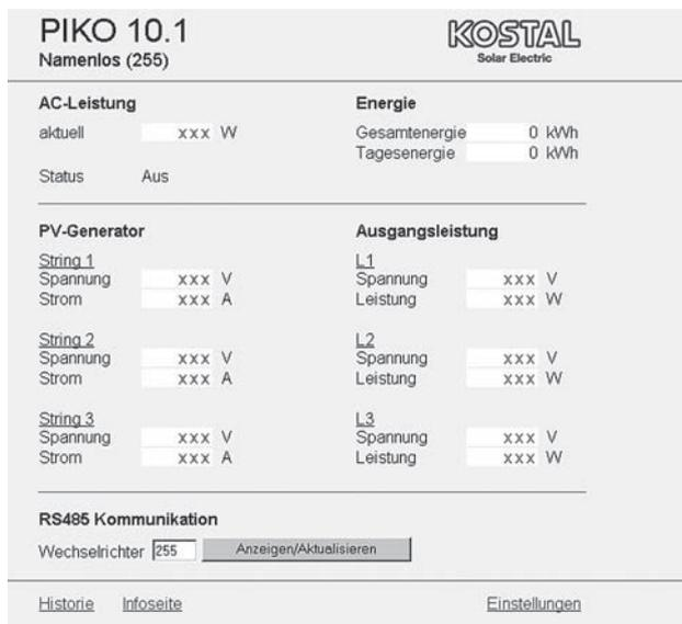
**Imagem 92:** Página principal do servidor Web (a quantidade de entradas- e saídas apresentadas pode variar conforme o modelo do aparelho.)
