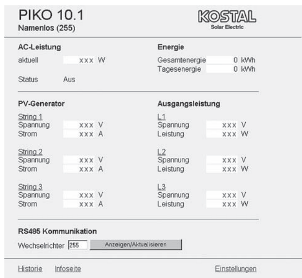
Afbeelding 92: Hoofdpagina van de webserver (het aantal weergegeven in- en uitgangen kan variëren afhankelijk van het toesteltype)
