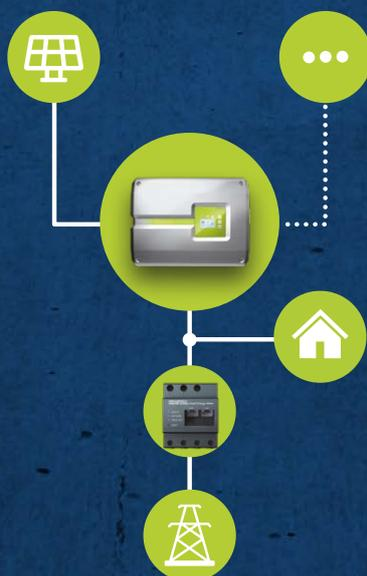
Grâce à un maximum de trois trackers MPP fonctionnant indépendamment les uns des autres, chaque orientation de panneau solaire peut être exploitée de manière optimale et efficace.
