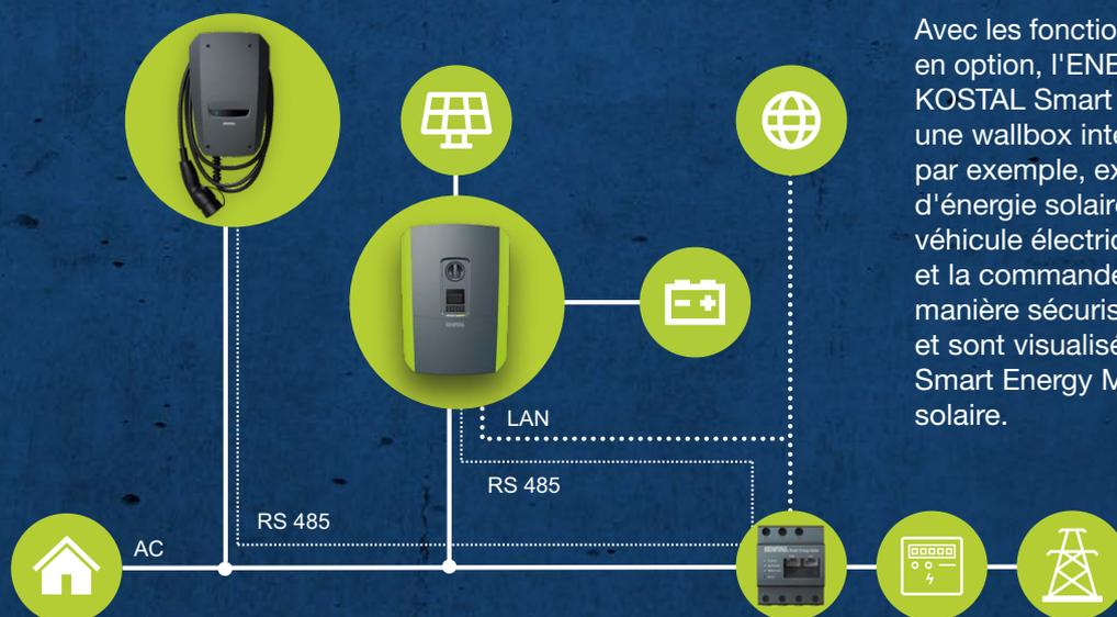
Avec les fonctions confort proposées en option, l'ENECTOR, associé au KOSTAL Smart Energy Meter, devient une wallbox intelligente et charge, par exemple, exactement la quantité d'énergie solaire disponible dans le véhicule électrique. La communication et la commande s'effectuent de manière sécurisée via une ligne RS485 et sont visualisées via le KOSTAL Smart Energy Meter dans le portail solaire.
