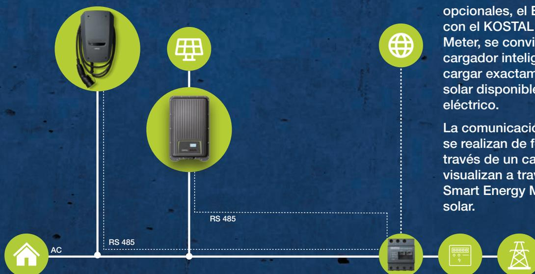
Con las funciones de confort opcionales, el ENECTOR, junto con el KOSTAL Smart Energy Meter, se convierte en un cargador inteligente, pudiendo cargar exactamente la energía solar disponible, en el vehículo eléctrico.
