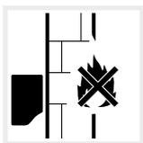
Wechselrichter auf nicht entflammbarer Montagefläche montieren.
