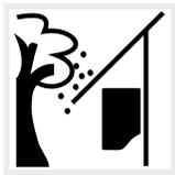
Wechselrichter vor herabfallenden Teilen schützen, die in die Lüftungsöffnungen des Wechselrichters gelangen können.
