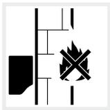
Wechselrichter auf nicht entflammbarer Montagefläche montieren.
