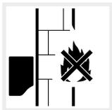
Monter vekselstrømsomformeren på en ikke-antændelig monteringsflade.
