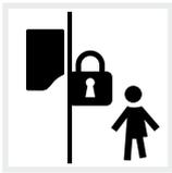
Montare l'inverter in modo inaccessibile a bambini.
