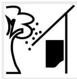
Proteggere l'inverter dalla caduta di pezzi che possono finire nelle aperture di areazione dell'inverter.
