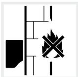
Monter l'onduleur sur une surface de montage ininflammable.
