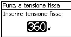
L'apparecchio può regolare la tensione di ingresso su un valore impostabile manualmente. In tal modo si disattiva l'impostazione automatica dell'inseguimento MPP. La tensione di ingresso può essere impostata in un range i cui estremi corrispondono alla tensione di ingresso massima e minima a passi di 1 V.
