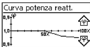
1. ➤ La curva caratteristica della potenza reattiva impostata viene visualizzata sotto forma di grafico (esempio in fig. a sinistra).
