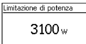
La potenza di uscita dell'inverter può essere limitata manualmente fino a minimo 500 W. Se la potenza è stata limitata manualmente, sulla visualizzazione di stato compare il simbolo **Riduzione potenza** e il valore misurato **"Riduzione potenza" / "Causa: Progr. utente"**.
