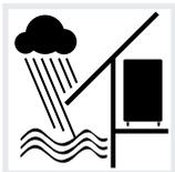
Batteriesystem in überschwemmungssicheren Bereichen aufstellen.
