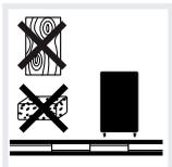
Batteriesystem auf eine stabile ebene Fläche aufstellen, die das Gewicht sicher tragen kann.
