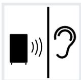
Batteriesystem kann im Betrieb Geräusche verursachen. Batteriesystem so montieren, dass Menschen durch die Betriebsgeräusche nicht gestört werden können.
