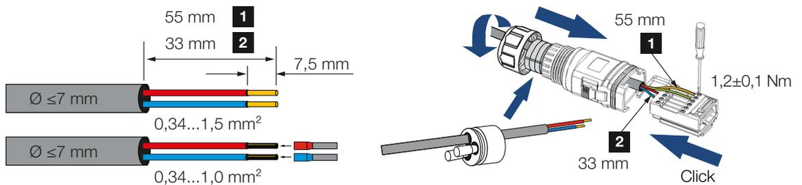
6. Monte el cable RS485 en el conector del inversor.
