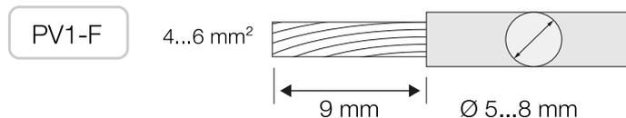
2. Inserte el extremo del cable pelado en el cuello de crimpado del contacto.
