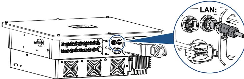
5. Apriete la cubierta LAN con el par de apriete especificado.
