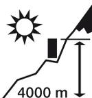
El inversor solo debe montarse hasta una altura de 4000 m.
