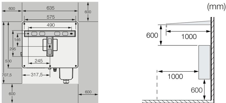
4. En caso de varios inversores uno al lado del otro, mantenga las distancias. Los valores indicados son distancias mínimas. Aumente las distancias si las condiciones térmicas del entorno de la instalación lo requieren, por ejemplo, en caso de ventilación desfavorable o irradiación solar fuerte.
