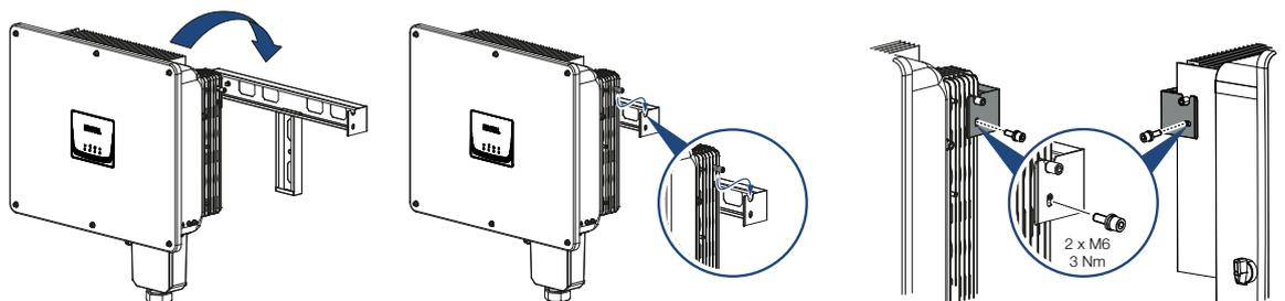
4. Asegúrese de que el inversor esté bien fijado y no pueda deslizarse del soporte.
