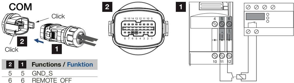
7. Monte el conector y apriete la tuerca de unión con el par de apriete especificado. Par de apriete: 3 Nm.
