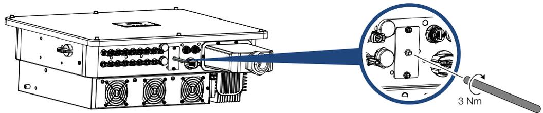
1. Retire la tapa protectora de la rosca de conexión del inversor.
