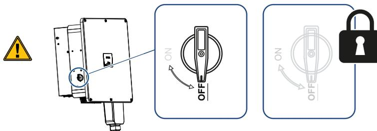
4. Espere al menos 10 minutos después de desconectarlo hasta que los condensadores internos se hayan descargado.
