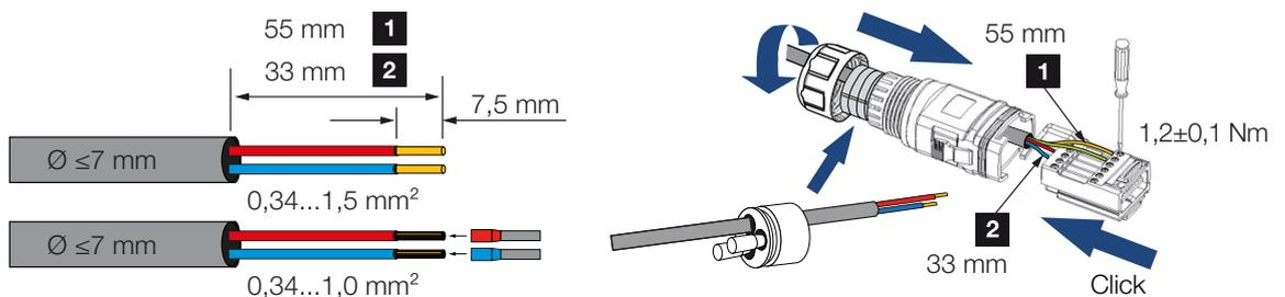
5. Monte el cable de comunicación en el conector del inversor.
