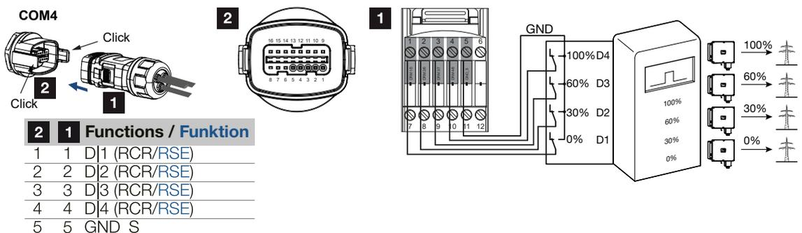
6. Monte el conector y apriete la tuerca de unión con el par de apriete especificado.
