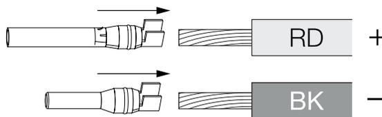
3. Crimpe el contacto con una herramienta de crimpado adecuada.
