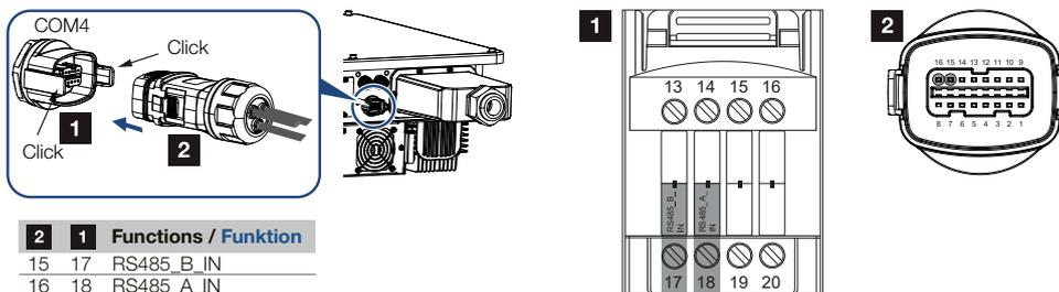
7. Monte el conector y apriete la tuerca de unión con el par de apriete especificado.
