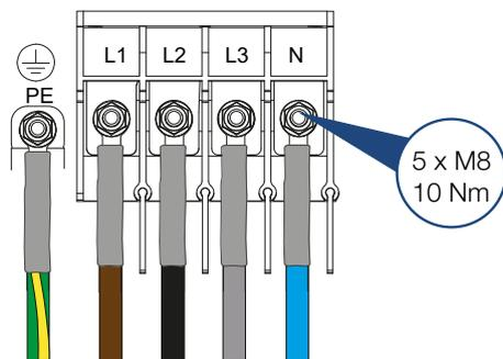
6. Atornille la tapa de conexión CA en la carcasa del inversor y el cable en la tapa de conexión CA. Par de apriete: tapa CA 1,2 Nm, cable 12 Nm.
