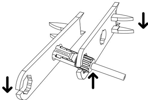
✓ Conector fotovoltaico montado
