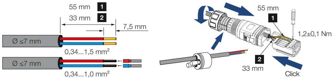
6. Monte el cable de comunicación en el conector del inversor.
