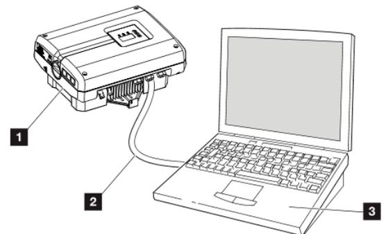
Abb. 52: Wechselrichter und Computer mit Ethernet-Kabel verbinden
