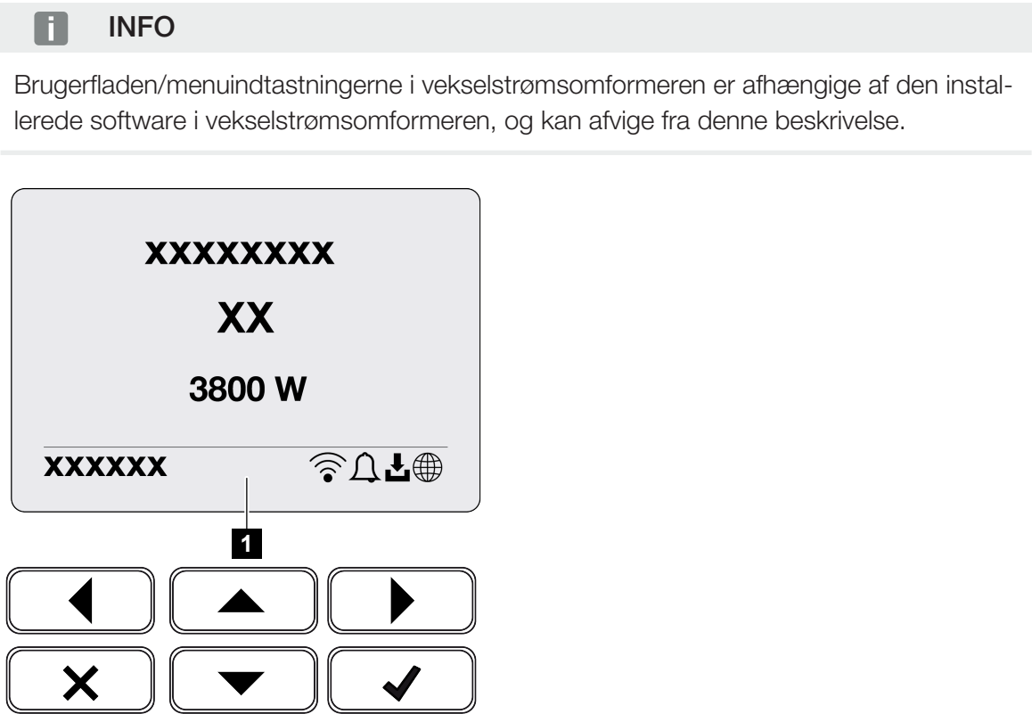
1 Displayområde, der viser informationer og vekselstrømsomformerstatus
