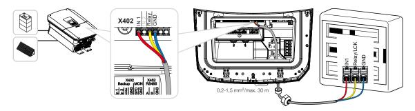
✓ Das Signalkabel der automatischen Backup Box ist angeschlossen.
