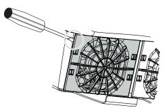
3. Mit einem zweiten Schraubenzieher die Befestigungslaschen zur Lüftermitte drücken. Lüftereinheit leicht hervorziehen.
