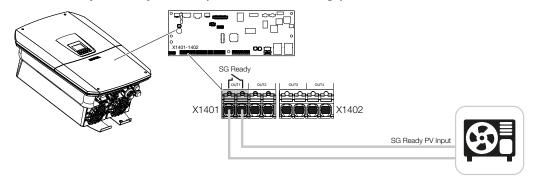
Die Verwendung der **SG-Ready**-Funktionalität ist eine einfache und kostengünstige Lösung, um den PV-Eigenverbrauch durch Nutzung einer Wärmepumpe zu erhöhen. Der Wechselrichter bietet die Möglichkeit, eine **SG-Ready**-kompatible Wärmepumpe anzusteuern.
