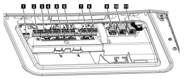
Das Smart Communication Board (SCB) ist die Kommunikations- und Schnittstellenzentrale. Auf dem SCB befinden sich alle Anschlüsse für die Kommunikation mit anderen Komponenten.
