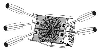
Lüftereinheit aus dem Gehäuse vollständig herausziehen. Dazu Steckverbindung des Lüfterkabels trennen.
