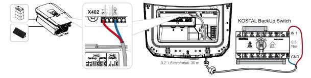
✓ Das Signalkabel vom KOSTAL BackUp Switch ist angeschlossen.
