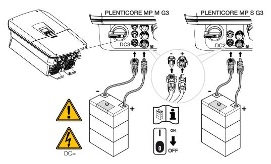
✓ Die DC-Leitungen der Batterie sind angeschlossen.
