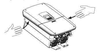
Zum besseren Transport des Wechselrichters benutzen Sie die Griffleisten links und rechts am Wechselrichter.
