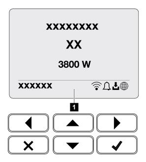
1 Displaybereich, der Informationen und den Wechselrichterstatus anzeigt
