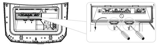
4. Stecken Sie das DC-Überspannungsmodul in den Steckplatz, bis es einrastet.
